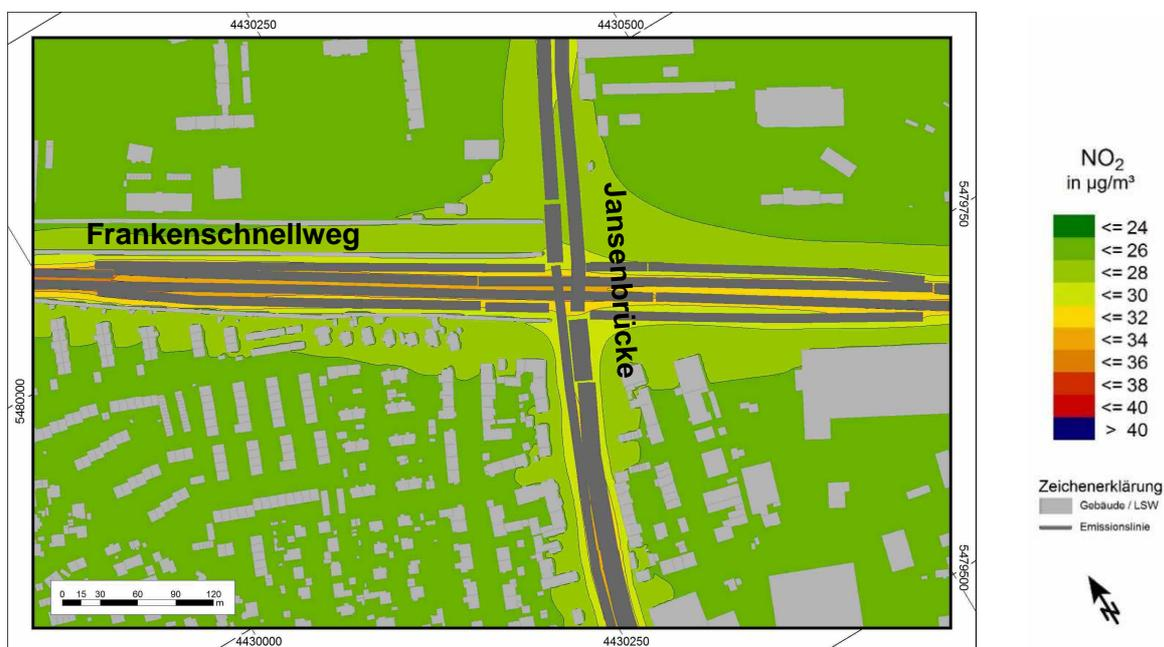
Abbildung 5: NO<sub>2</sub>-Gesamtbelastung im Prognosebezugsfall, Abschnitt FSW – Jansenbrücke
