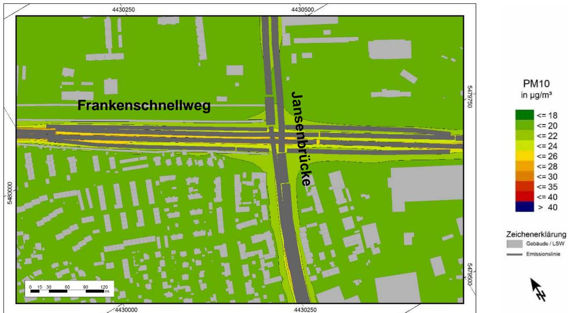
Abbildung 7: PM10-Gesamtbelastung im Prognosebezugsfall, Abschnitt FSW – Jansenbrücke
